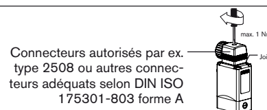
Fig. 3 : Raccordement électrique du connecteur
